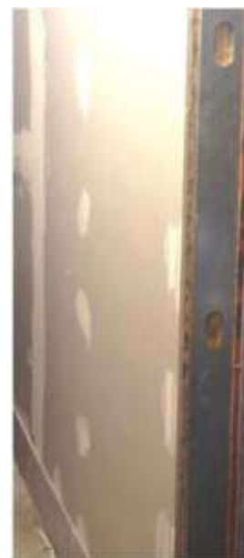
FiguraA.3-Detalle del cuerpo de prueba tras el tratamiento de juntas de las placas.
