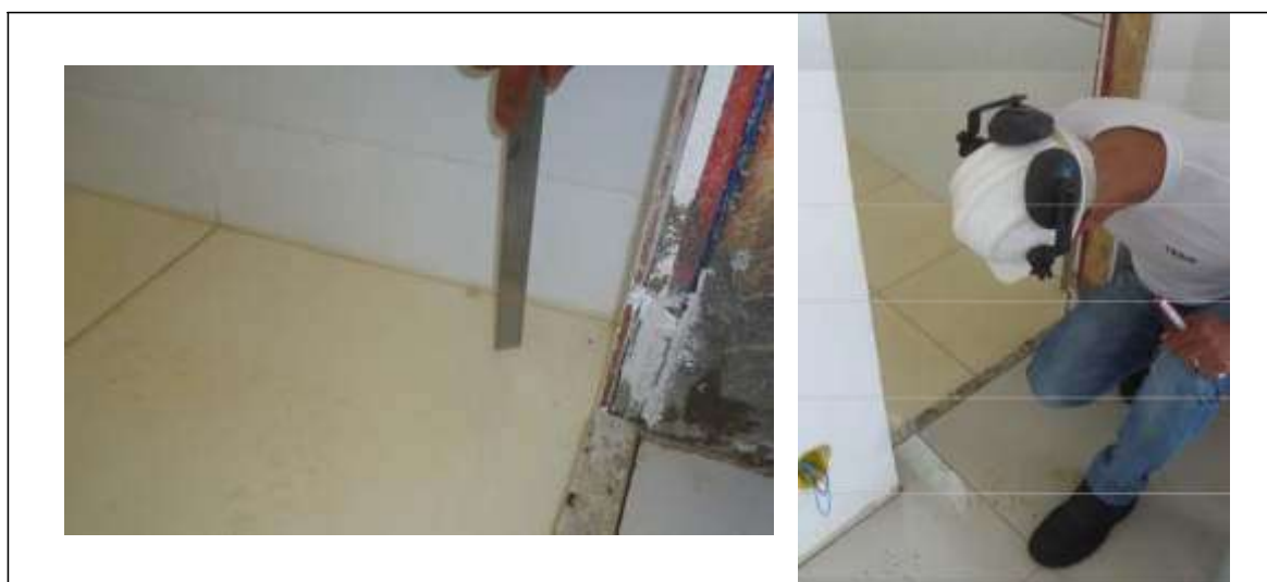
Figura 12: realización del ensayo de estanqueidad del sistema de piso en áreas mojadas
