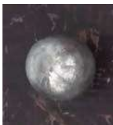
Figura 7: foto de la esfera de impacto de cuerpo duro de 1kg. Los resultados del ensayo de impacto de cuerpo duro se ven en la tabla 7.
