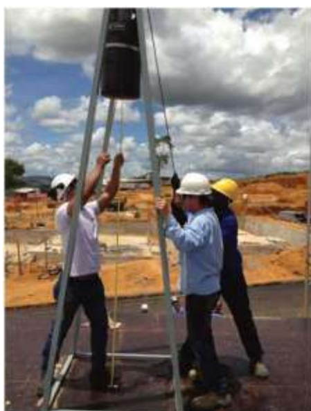
Figura 4: foto tomada durante la realización del ensayo de impacto de cuerpo blando en el sistema de piso.
