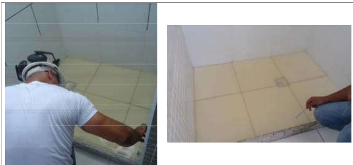
Figura 11: realización del ensayo de estanqueidad del sistema de piso en área mojada
