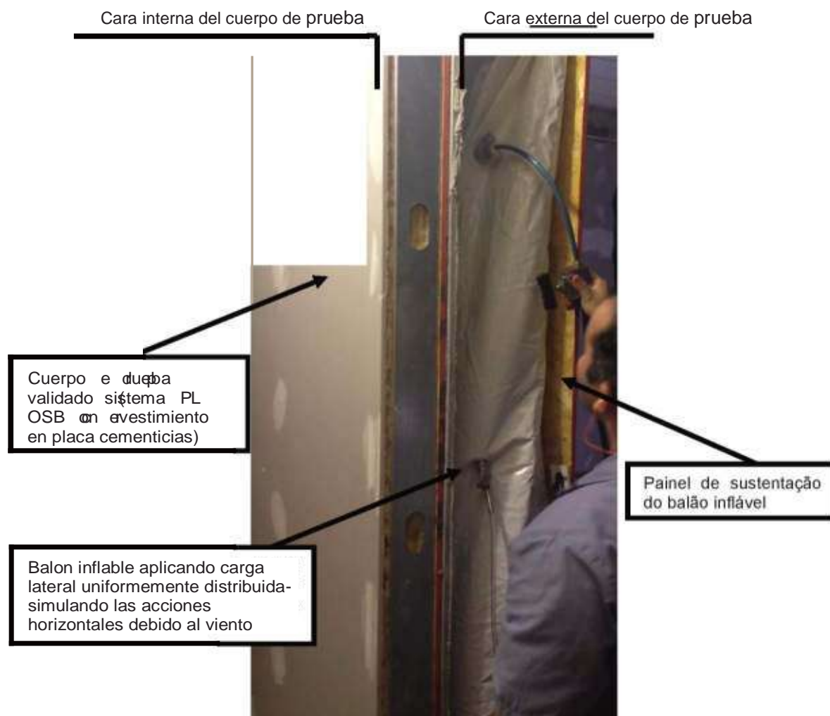
Figura 3-Aplicación de carga lateral uniformemente distribuida
