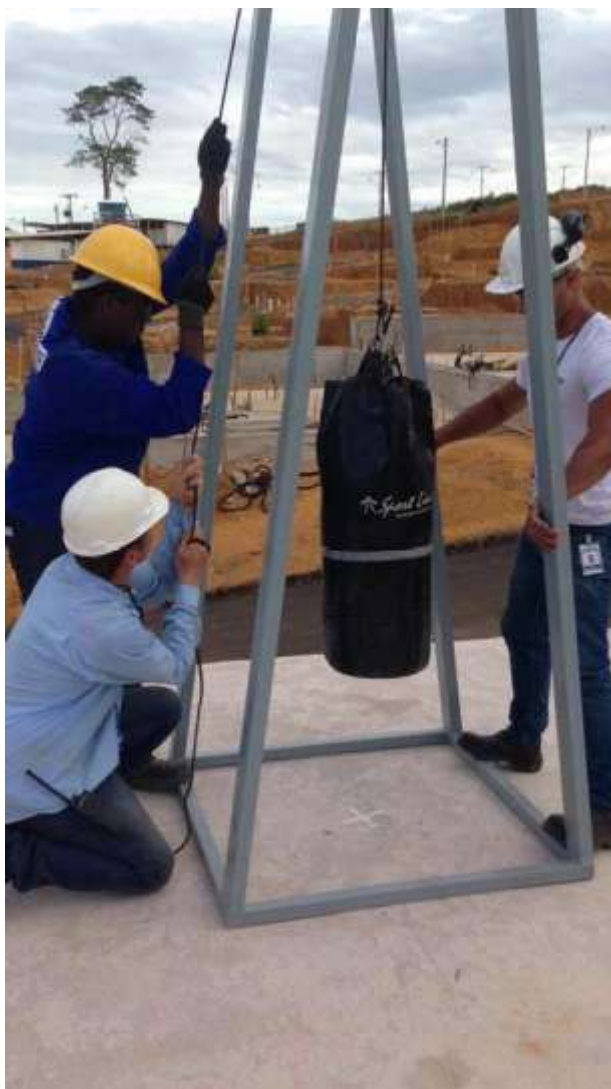
Figura 4: foto tirada durante la realización del ensayo de impacto de cuerpo blando en el suelo.
