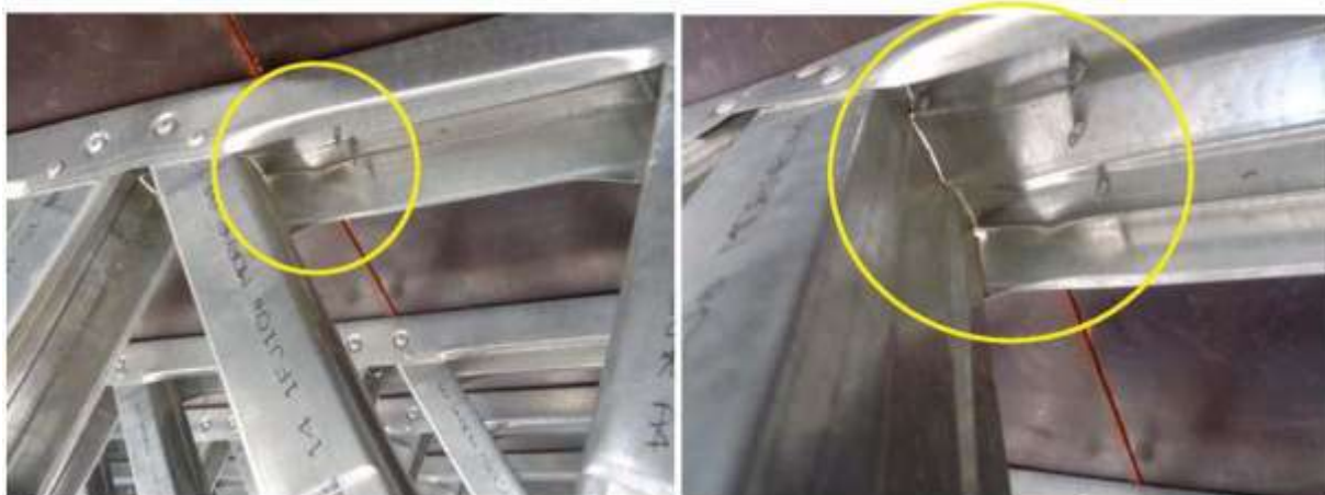
Figura 6: vista de la deformación ocurrida en el perfil durante el ensayo de impacto de cuerpo blando en el sistema de piso sobre el perfil (tabela 6).
