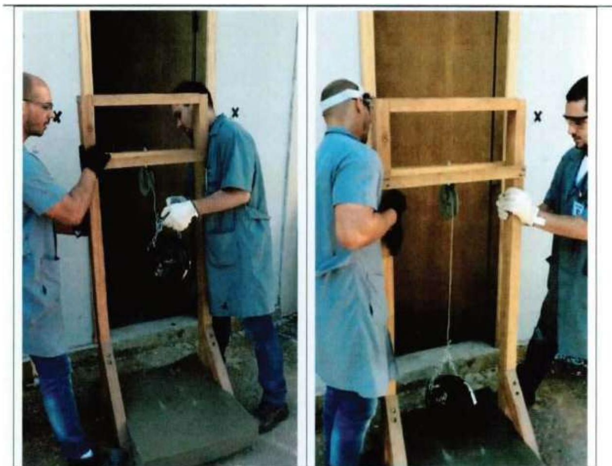
Figura 2—cerrado brusco de la puerta—ejecucion del ensayo
