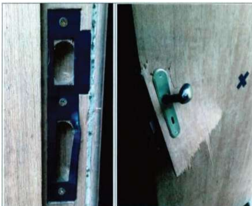
Figura 4- Detalle del sistema después de impactos en sentido a la abertura.
